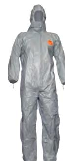
Cette combinaison résistante aux produits chimiques avec capuche intégrée protège contre de nombreux produits chimiques inorganiques et organiques. Protection contre les particules radioactives et les risques biologiques. Peut également être utilisée dans les zones ATEX, si la mise à la terre est appropriée. Assure une résistance aux projections de liquides jusqu'à 5 bar.
