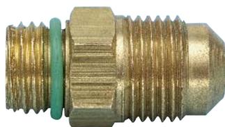
**Pour adapter des raccords d'entretien rapides avec filetage femelle M14x1,5 sur les flexibles d'entretien à filetage femelle de 3/8 pouce SAE**
