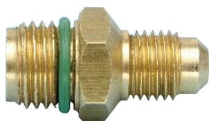
Pour adapter des raccords d'entretien rapides avec filetage femelle M14x1,5 sur les flexibles d'entretien à filetage femelle de 1/4 pouce SAE.
