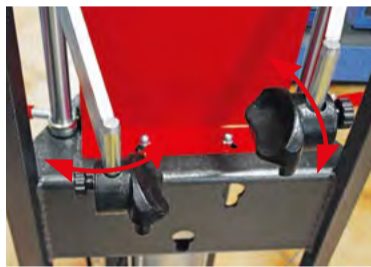
Adaptation des griffes à l'inclinaison des spires du ressort
