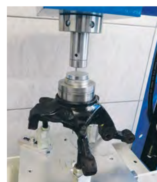
Remontage de roulement sur presse d'atelier
