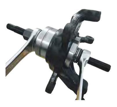
Remontage de roulement sur établi ou directement sur le véhicule
