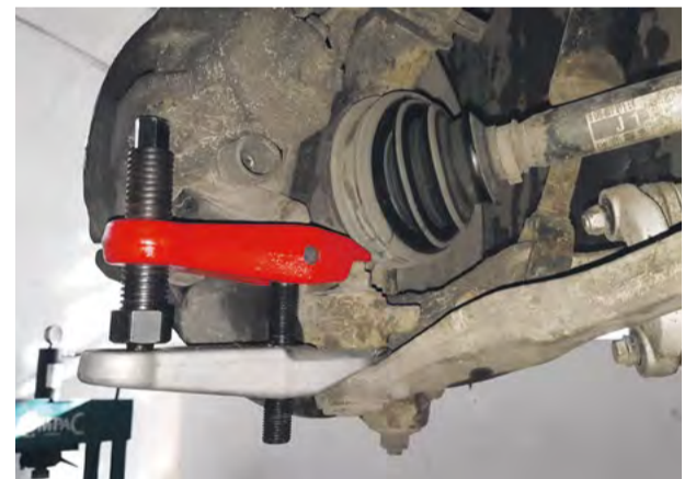
Audi - démontage tête de barre de liaison
