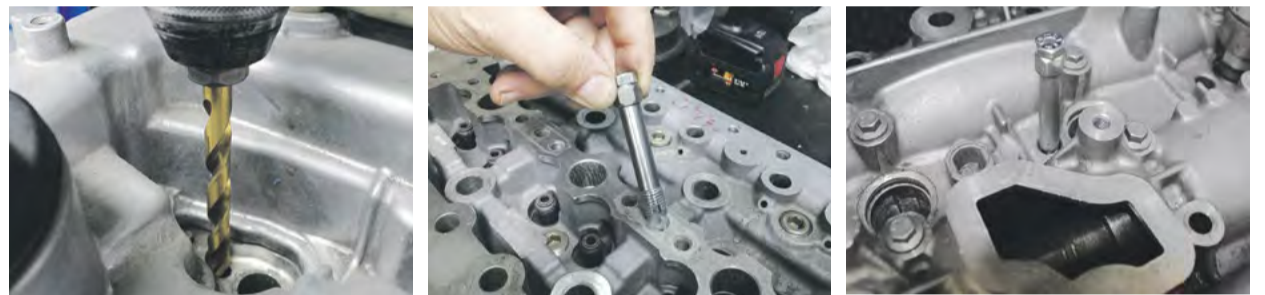
Pose de l'insert sans cache culbuteur
