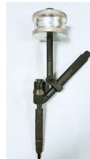
Raccordement au filetage de l'embout d'alimentation de l'injecteur.
