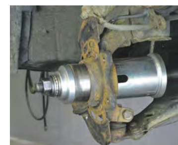
montage roulement de roue- en butée sur le logement du roulement
