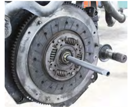
Centrage du disque d'entraînement avec le roulement guide
