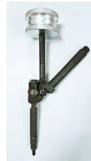
Raccordement au filetage de l'embout d'alimentation de l'injecteur.
