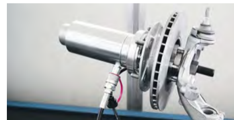
Dépose du moyeu avec disque de frein - Changer le roulement de roue
