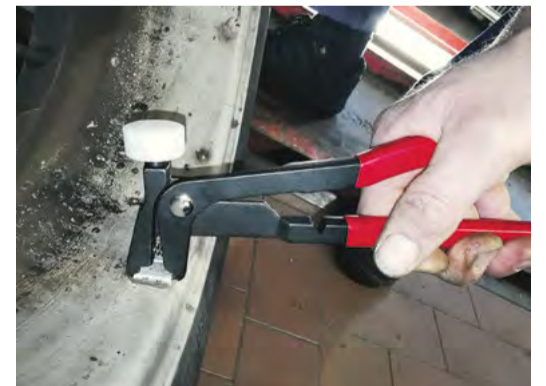
Montage de masses à frapper
