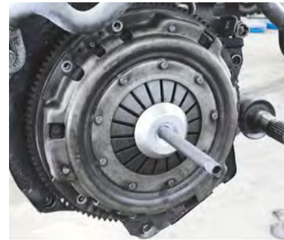
Centrage du disque d'entraînement lorsqu'il n'y a pas de roulement guide
