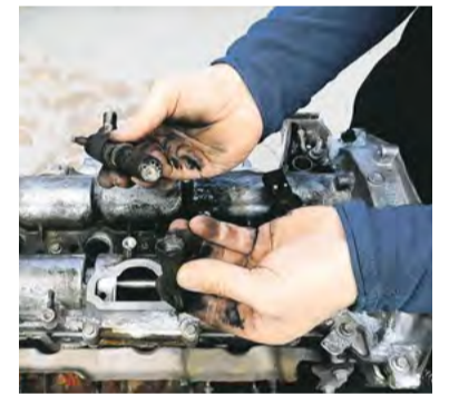
Démontage d'injecteurs brisés
