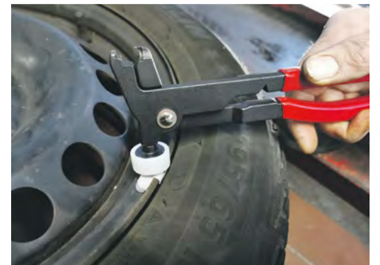
Montage de masses à frapper
