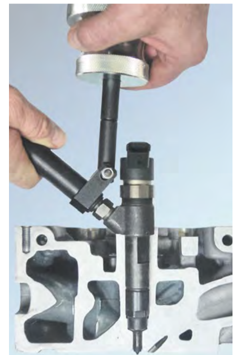
Raccordement au filetage de l'embout d'alimentation de l'injecteur.
