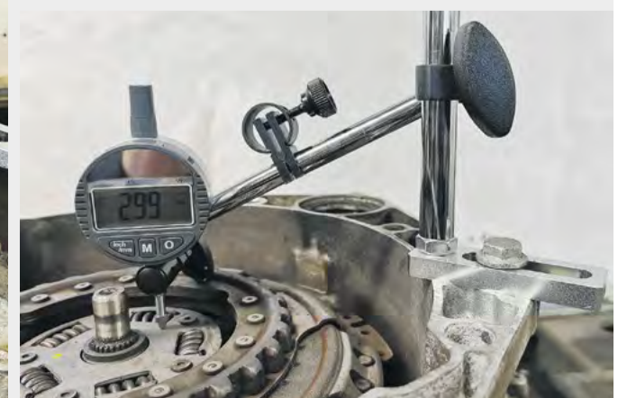
Vérifier le jeu de hauteur de l'embrayage DSG
