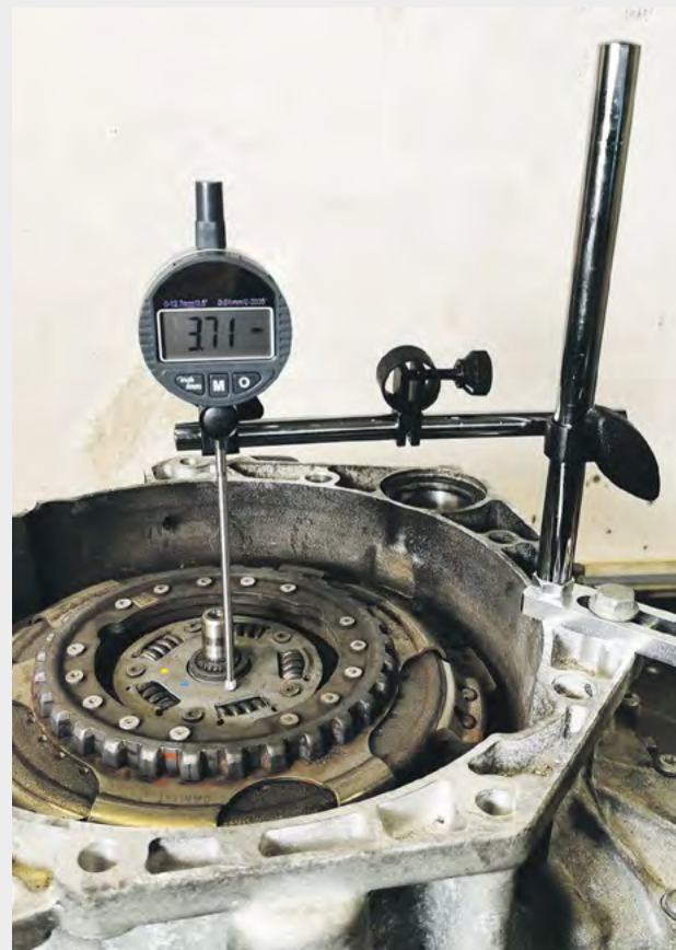
Mesure du jeu en hauteur avec extension de palpeur
