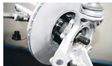
Dépose du moyeu avec disque de frein - Changer le roulement de roue
