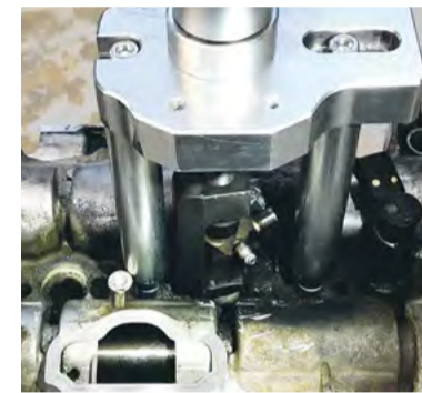
Extraction avec traverse et fourche
