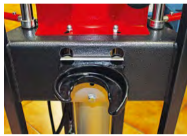
Coupelle inférieure fixation sans outil
