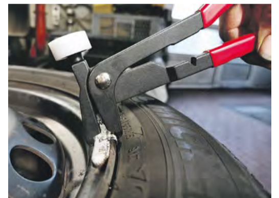
Démontage des masses à coller
