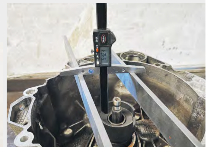
Vérifier le jeu de hauteur de l'embrayage DSG
