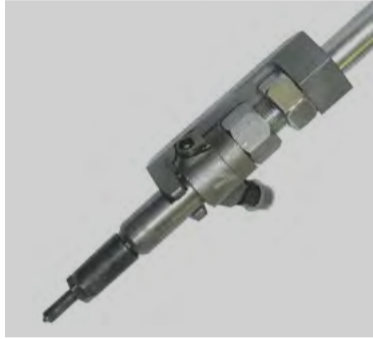
Extraction d'injecteur diesel
