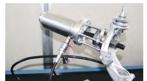
Dépose du roulement de roue sur le véhicule - Changer le roulement de roue
