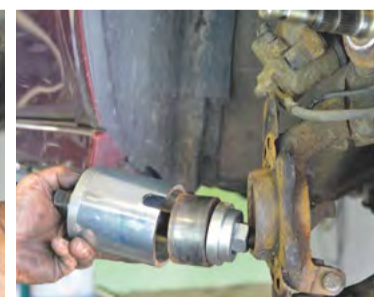
roulement de roue démonté
